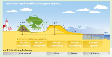
An den Außenküsten Mecklenburg-Vorpommerns wird an  $vielen\, Flachk \"{u}sten abschnitten\, das\, sogenannte\, {\it "kombinierte}$ Küstenschutzsystem" verwendet, das in der Regel aus einem
